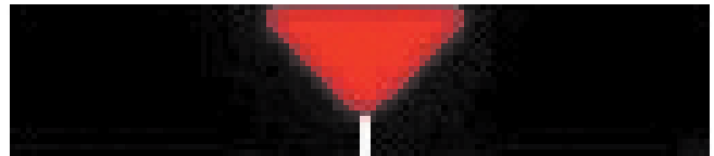
Soldadura incompleta, dejando un hueco en la raíz, lo que favorece la corrosión
